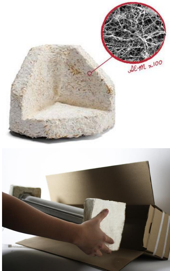
Gambar 3. Struktur jamur miselium dan kemasan jamur Dell Sumber: www.dell.com
